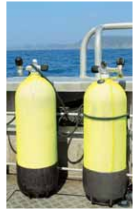
Une bouteille de plongée doit toujours être attachée ou couchée.
